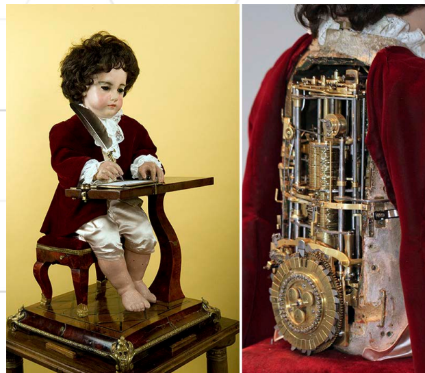
چرخ‌دنده‌های عروسک نویسنده به گونه‌ای طراحی شده‌اند که دست‌ها را برای نوشتن یک متن صحیح حرکت دهند!
